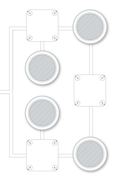
VARIODYN® D1 Loop Technology ist die neue Technologie zur Optimierung der Ausfallsicherheit der Lautsprecheranbindung. Hier wird – ähnlich wie bei der Brandmeldetechnik – ein drahtbruch- und kurzschlusstoleranter Ring aufgebaut.
